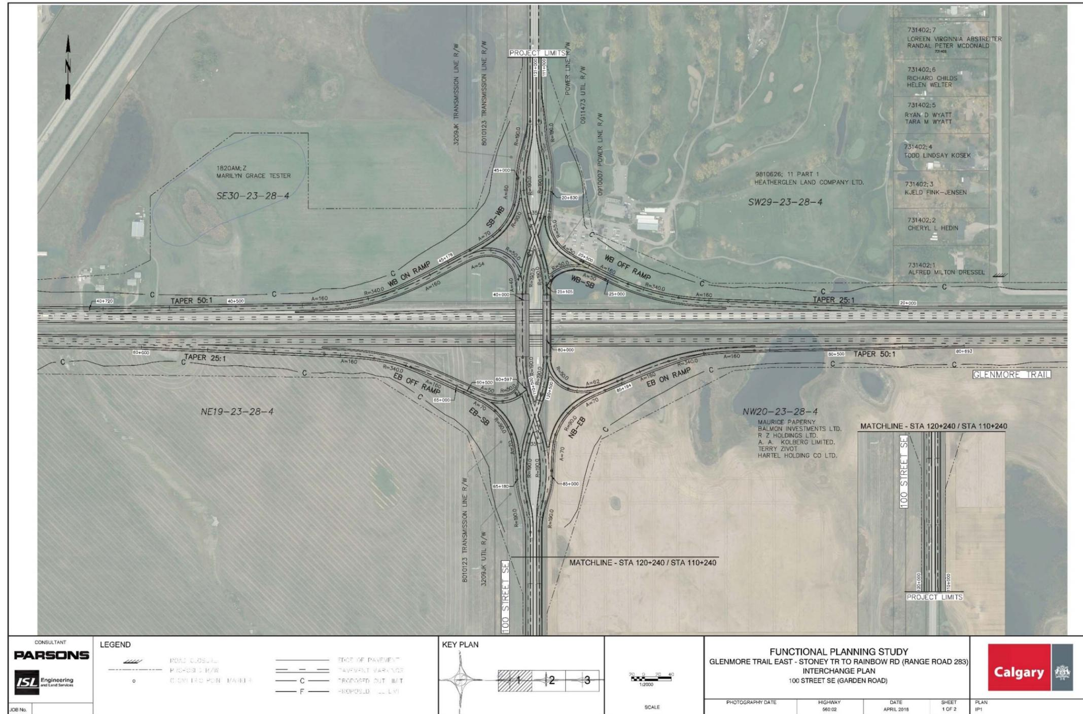
FIGURE E.7: RECOMMENDED PLAN - 100 ST SE
