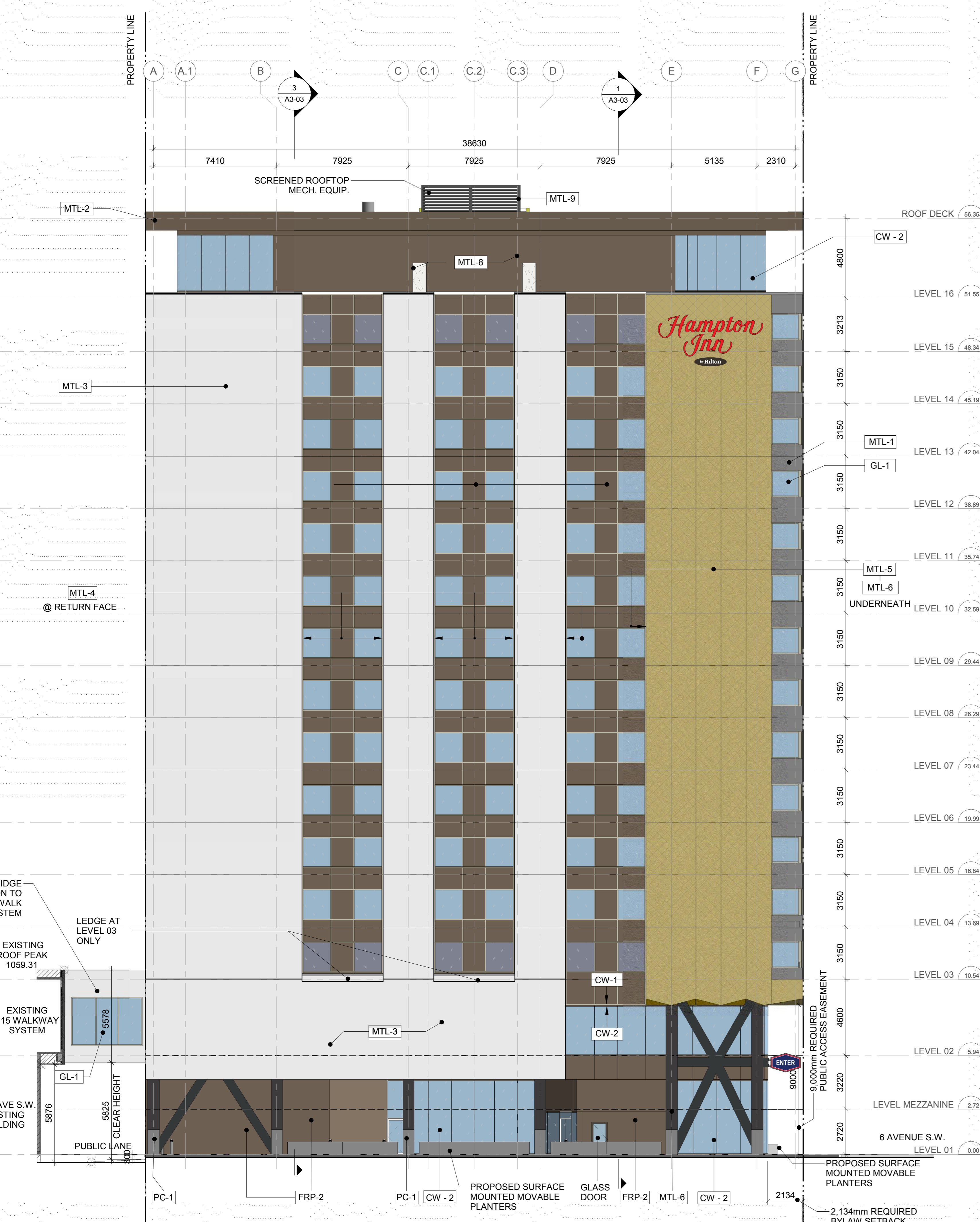
2 WEST ELEVATION SCALE: 1:125
